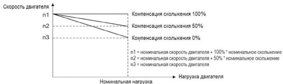
Компенсация скольжения в режиме вращения двигателя
